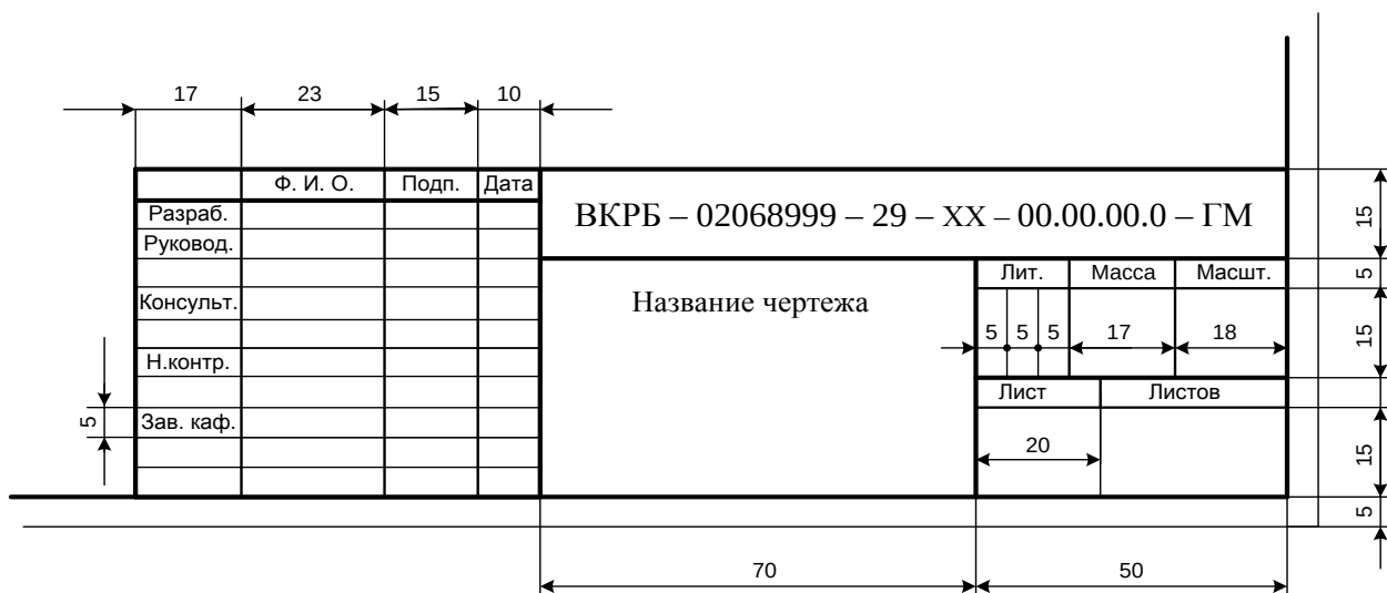
Рис. 11.2. Оформление основной надписи для чертежей и схем
